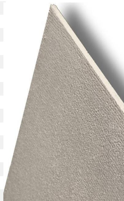
**Lastra in cemento alleggerito fibrorinforzato ottenuta con un impasto di cemento e perline di polistirene. La lastra è molto leggera e resistente all'acqua, non marcisce e non si deforma, è rinforzata sulle due facce, fronte e retro con rete di fibra di vetro**
